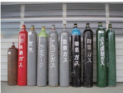
圧縮ガス液化ガス容器
